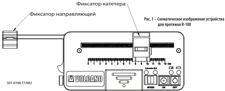
Рис. 1 – Схематическое изображение устройства для протяжки R-100
